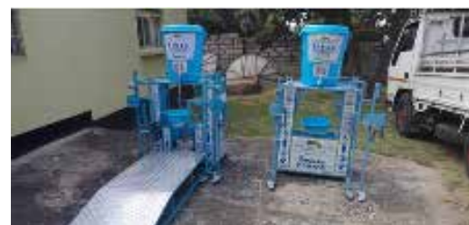
Instalaciones para el lavado de manos para personas con discapacidad
